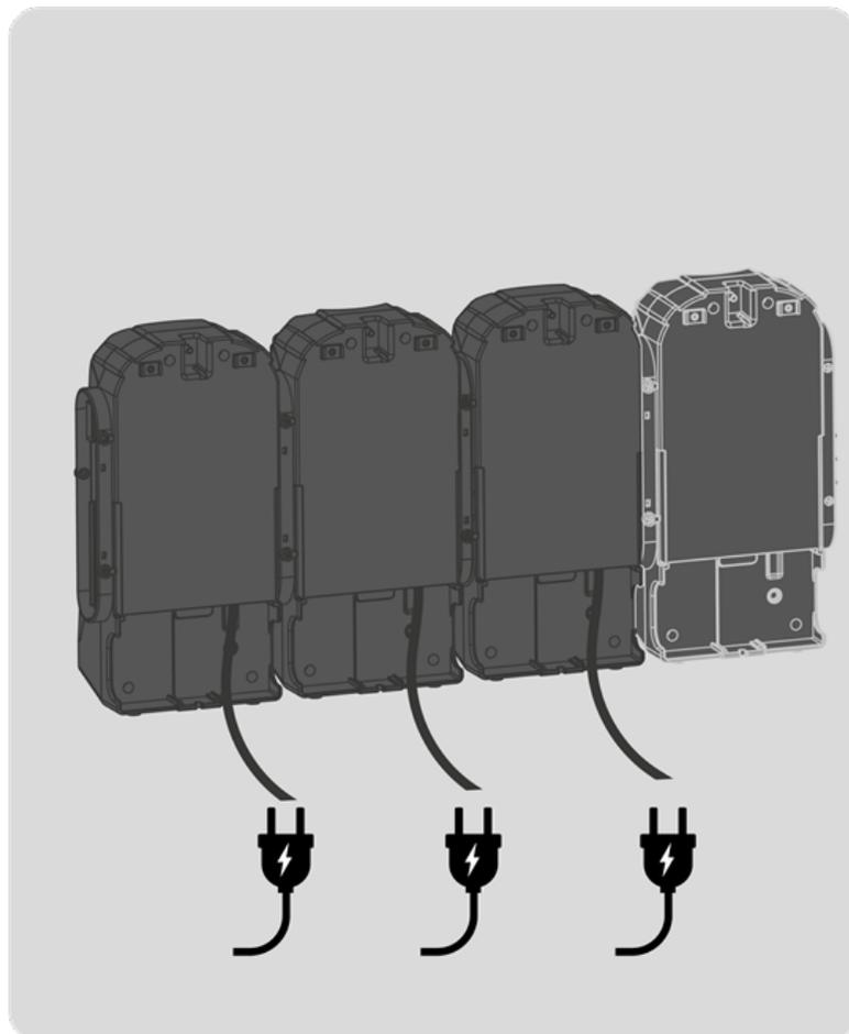
(14) Insérer la fiche d'alimentation dans la prise d'alimentation de chaque banc d'essai.
